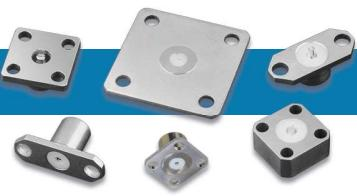
我们的带状线法兰负载是同轴隔离器应用的理想选择。很多设计都具有无焊接结构的特点。将电阻杆元件插入外壳，形成可靠性很高的压缩配合，因此获得了优异的电气性能，不受后续高温制造工艺的影响。这些产品中有很多符合航天应用要求，可进行高可靠性应用测试。
