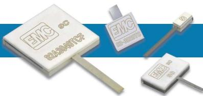
微带片式负载是无法兰器件，带有保护性的陶瓷片式和微带触头，在任何类型的组件中都能发挥最高性能。它们的设计是直接将焊料粘附在散热器或电路板(需要散热通道)上，实现绝佳的热传递。这些器件在宽波段上具有出色的驻波比(VSWR)。频率范围：其工作频率是直流到18GHz。额定功率范围：从10到500W。大多数设计都可选择引线成形。
