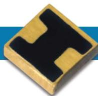
史密斯英特康技术提供一系列CVD金刚石片式衰减器，其额定功率极高。这些产品的工作频率为直流到26.5 GHz，具有大功率处理能力、宽频率响应和小覆盖区，因此非常适合军事和航天应用。CA0505D制造时采用全薄膜结构。端子上的镀金层可采用引线键合，也可进行焊接。可提供标准片式与基于Mil-PRF-55342进行了高可靠性测试的片式产品。可选择卷带式封装或格栅结构封装。这些产品不含铅，符合RoHS要求，并得到了S级认证。现有标准值为1到10、20与30dB。
