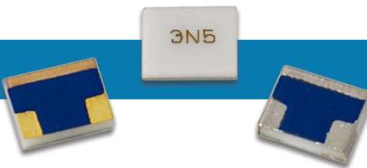
史密斯英特康的小型Thermopad®, 温度可变衰减器，符合S级要求，适用于高可靠性应用。作为一种全无源式温度补偿解决方案，Thermopad具有降低系统复杂性和提高整体可靠性的优势，这对于航天和军事应用至关重要。MTVA的HR系列经优化后适合频率范围是直流到18GHz，客户可根据 Mil-PRF-55342 要求，同时订购该系列产品和经过 A、B 或 C 组测试的产品。。
