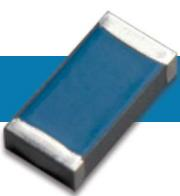
表面贴装片式电阻器可采用适合射频或直流应用(例如偏置压降或加热器)的三种不同的端子类型。A型端子采用全背面涂覆金属,用于直接贴装在散热器或待加热的器件上。B型端子具有环绕式功率分配器,用于小功率SMT应用。C型端子有分割地结构,端子可以作为电阻器或终端进行贴装。这种类型的端子提供更大的接地面积,可以增强散热性能,是大功率SMT应用的绝佳选择。
