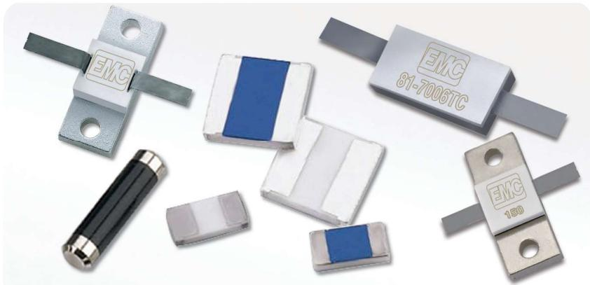
史密斯英特康技术提供大小功率射频阻器，包括表面贴装晶片、微带片式片式、法兰贴装和杆型。这些电阻器采用氧化铝、氮化铝、氧化铍和CVD基材。某些器件使用调谐电路设计来最大限度地减少可用波段上的寄生电容。大多数器件采用各种电阻值，通常为从1欧姆到1,000欧姆。
