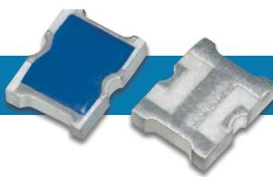
史密斯英特康的TS09片式衰减器的额定输入功率为200mw，衰减值为0 dB到10 dB，工作频率范围为从直流到20 GHz。该产品有各种金属喷镀及电镀选项，包括符合RoHS标准的银/镍电镀处理、镀锡/铅，以及焊料电熔处理（便于回流处理）。WB2型衰减器采用后膜引线键合式金端子。
