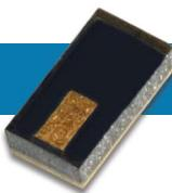
我们独家推出的CVD金刚石片式终端系列的独特之处在于封装体积极小，但额定功率极高。这些终端可用于从直流到28.0 GHz的应用，并且由于其具有大功率能力和小巧轻型的封装尺寸，非常适合军事和航天应用。这些终端在制造时采用全薄膜结构，且有着镀金表面材料，可采用引线键合或焊接。全薄膜结构也非常适合峰值功率应用。也可提供基于Mil-PRF55342进行了高可靠性测试的终端。可选择卷带式封装、散装或格栅结构封装。这些产品也不含铅，符合RoHS要求，并得到了S级认证。
