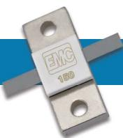
法兰电阻器非常适合直接贴装到散热器上，可改善散热效果。这些器件可采用单孔、双孔和四孔法兰贴装类型。这些器件的标准电阻值为50和100欧姆，但大多数设计可以使用非标准电阻值。这些法兰电阻器的额定功率范围为从10到1000W。很多设计采用氧化铍和氮化铝(AlN)基底。31-XXXX的以往设计一般采用薄膜电阻器，而5XXX设计则采用厚膜电阻器。
