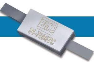
微带片式电阻器非常适合直接贴装到散热器或电路板上。这些电阻器采用的材质有氧化铍、氮化铝(AlN)或氧化铝基底。这些器件的标准电阻值为50和100欧姆，但也可以使用许多非标准电阻值。额定功率范围：从10到500W。应用包括需要对地电容较小的威尔金森功分器/组合器。封装可选择托盘式或卷带式封装。
