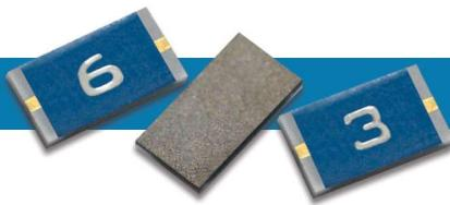
史密斯英特康技术的KFA系列固定衰减器的覆盖区与KTVA相容,工作频率范围为16-36GHz。标准衰减值:1 - 10 dB。KFA也适用于高可靠性应用(HRKFA零件编号),根据HRKFA进行A、B或C组测试。这种衰减器可与引线键合用金端子和铂银结合使用,并可焊接在接地平面上。
